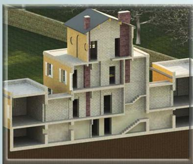
*Maquettes numériques de bâtiments existants réalisées par nos équipes sous Revit Architecture sur la base de relevés d'intérieurs en 3D*
